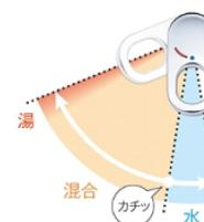
湯と水の混合切替時に力チップ
